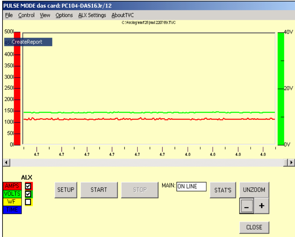
Figuur 26: stroom-spanningsverloop Fronius magic wave 2600 gelijkstroom
