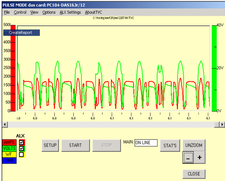
Figuur 28: stroom-spanningsverloop Fronius magic wave 2600 gepulseerd 100Hz
