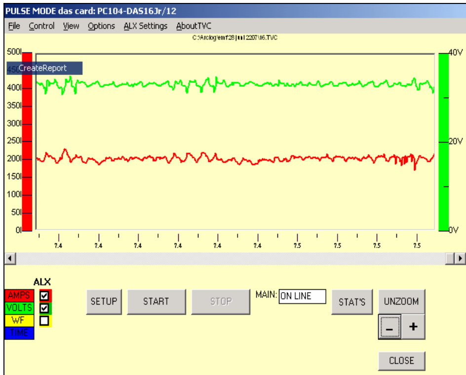
Figuur 20: stroom-spanningsverloop Kemppi pro 4200 sproeibooglassen
