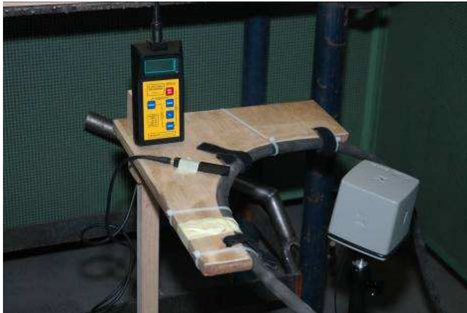
Figuur 15: meetopstelling prEN 50444
